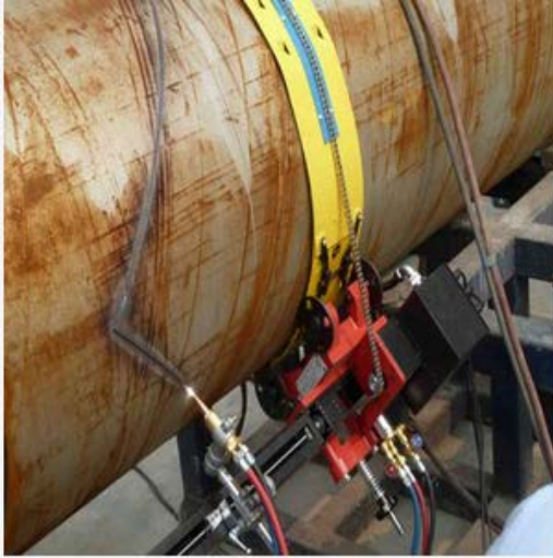
工程描述: 厂中除尘设备制造 管道相贯线切割 设备型号: 新戈派 (ThinkPipe) -X80A 切割范围: 管径320mm-1500mm
