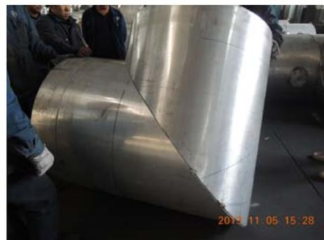
图7 内弯外皮相接，外弯内皮相接
